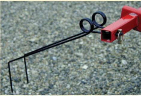
Verschleißfeste Doppelzinken Ø7 mm x 600 mm, welche mit einem 11 mm Federstecker gesichert sind. Für schwere und lehmige Böden ist ein Doppelzinken Ø7 mm x 450 mm lieferbar. Der Zinkenwechsel erfolgt schnell und werkzeuglos.
