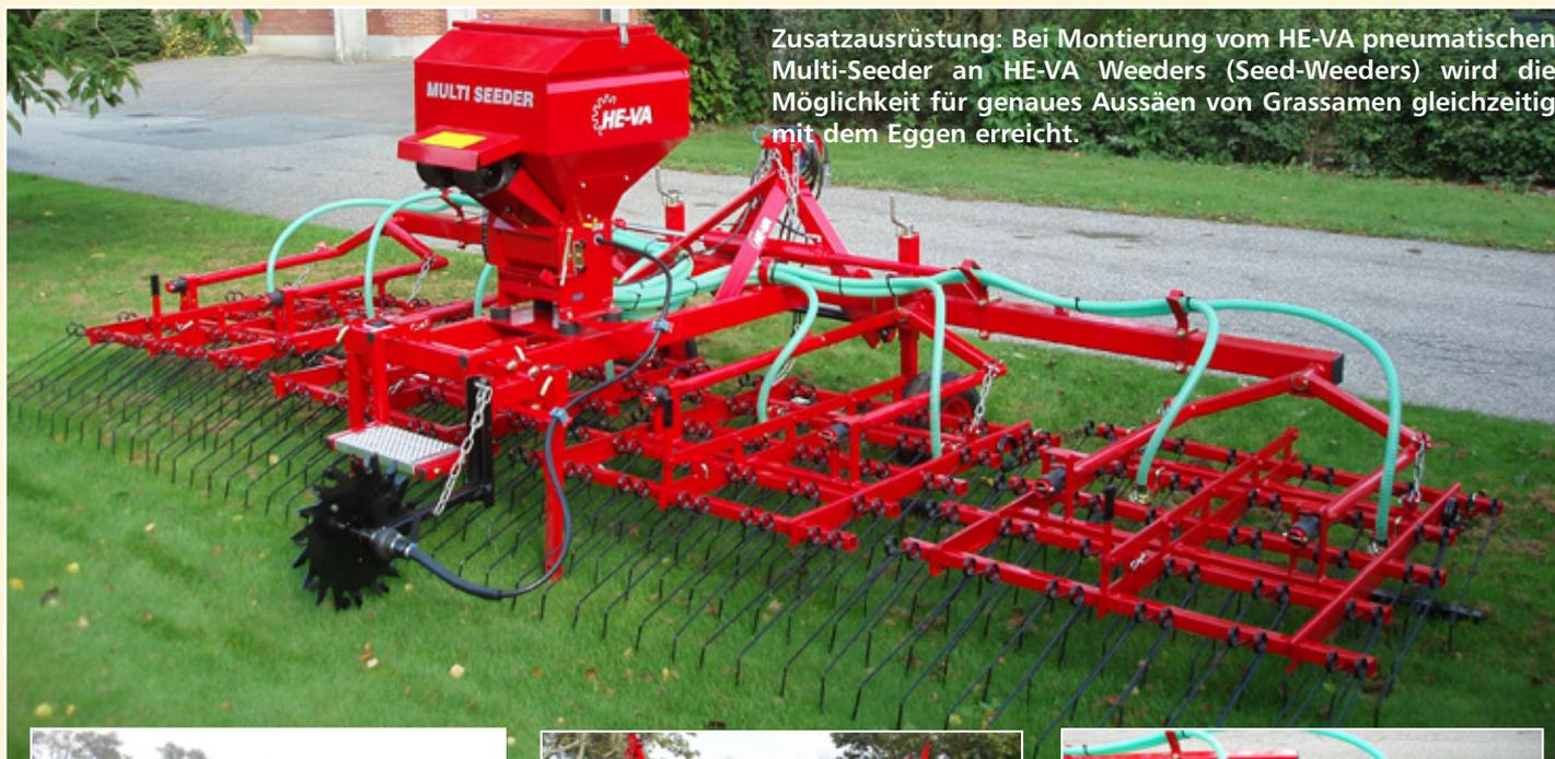
Zusatzrüstung: Bei Montage vom HE-VA pneumatischen Multi-Seeder an HE-VA Weeders (Seed-Weeders) wird die Möglichkeit für genaues Aussäen von Grassamen gleichzeitig mit dem Eggen erreicht.
