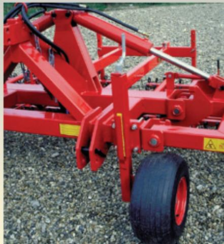
Höhenverstellbare Tragräder, 16 x 6,5, 6 PLY an 3 m - 7,5 m. An 9 und 12 m werden weiter 2 Stck. 18,5 x 8,5 x 8, 6 PLY verwendet. Jedoch werden größere Räder an den Weeder HD Modellen verwendet.
